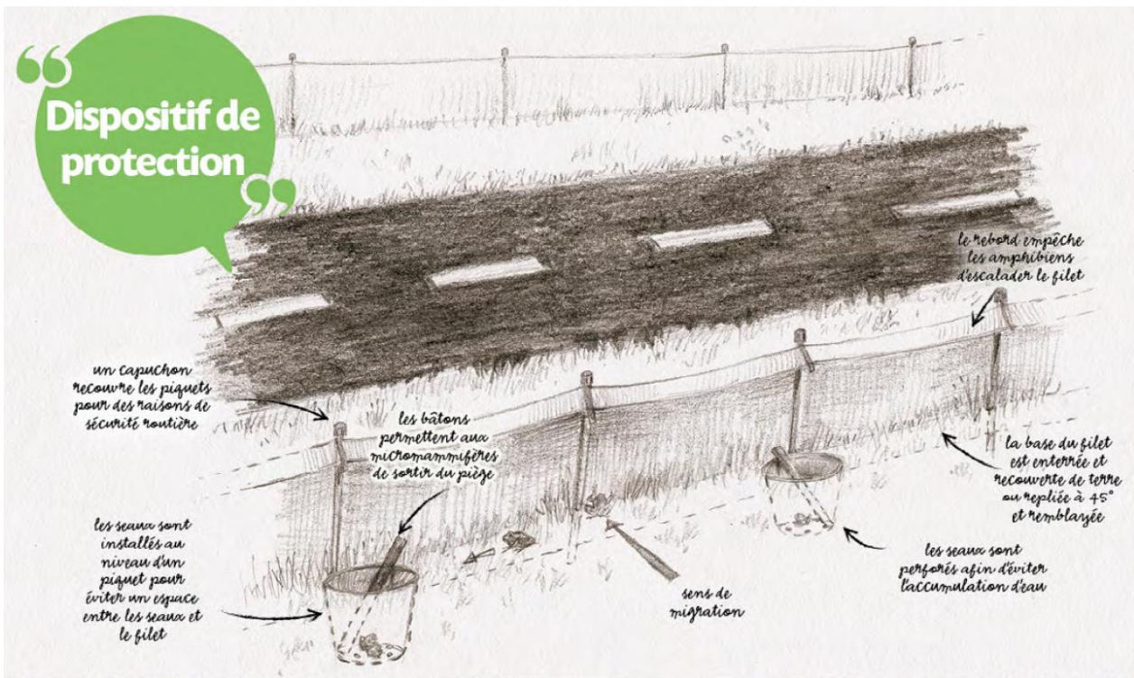
Dessin schématique d'un dispositif routier de sauvetage des amphibiens issu du Guide de détermination des amphibiens d'Alsace, Conseil départemental Haut-Rhin, BUFO Alsace.
